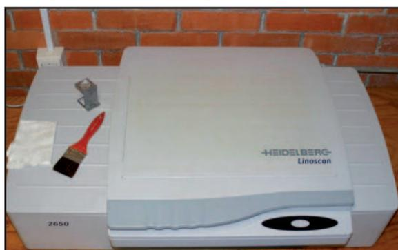
Fig 2.- Escáner de cama plana Heidelberg Lino scan 2650, 2400 dpi. Si se utiliza un escáner de cama plana para digitalizar, se debe utilizar un escáner profesional de alta resolución, desafortunadamente se están dejando de producir este tipo de escáneres, como el de la imagen.
